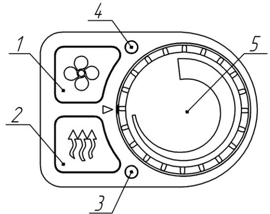
LED Pos. 3 zeigt den Zustand im Heizbetrieb an:
